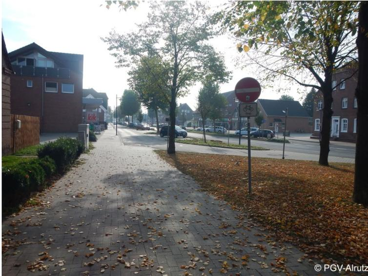
Abb. 4-22: Für den Radverkehr in Gegenrichtung geöffnete Einbahnstraße (Papenburg, Splitting links)
