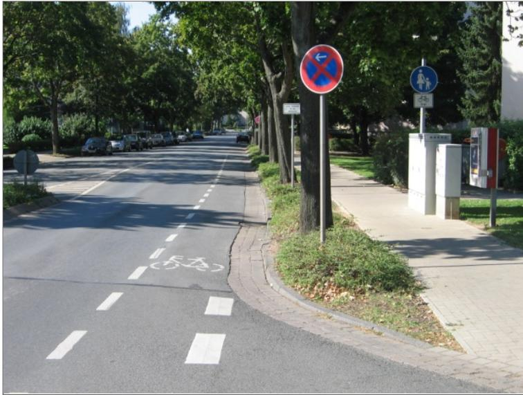
Abb. 4-11: Kombination von Schutzstreifen mit Gehweg, Radverkehr frei (Hameln)
