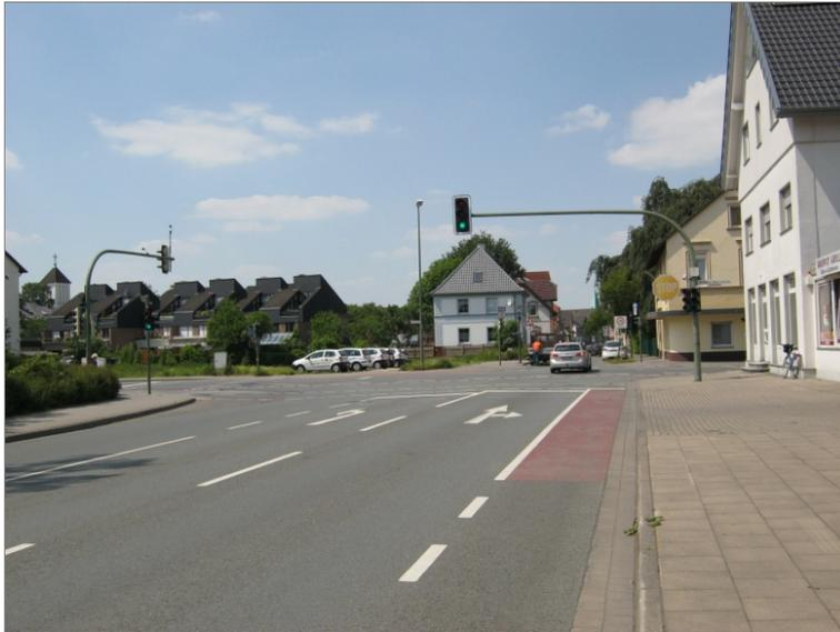
Abb. 4-18: Vorbeifahrstreifen in einer signalisierten Knotenpunktzufahrt (Bielefeld)
