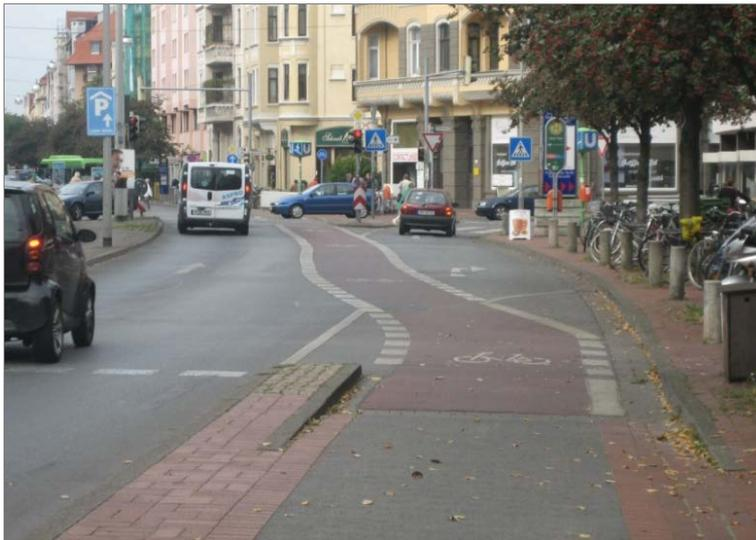
Abb. 4-17: Übergang Radweg in Radfahrstreifen an signalisiertem Knotenpunkt (Hannover)
